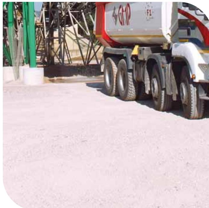
Il carico degli inerti avviene direttamente dalla tramoggia all'autocarro, limitandone lo stoccaggio a terra e quindi il potenziale imbrattamento. È stato inoltre installato un secondo mulino di frantumazione e un secondo sistema di lavaggio "idrociclone" per la produzione delle sabbie, che oltre a consentire una maggiore produzione, permette di ottenere un prodotto perfettamente pulito e privo di residui limosi.
